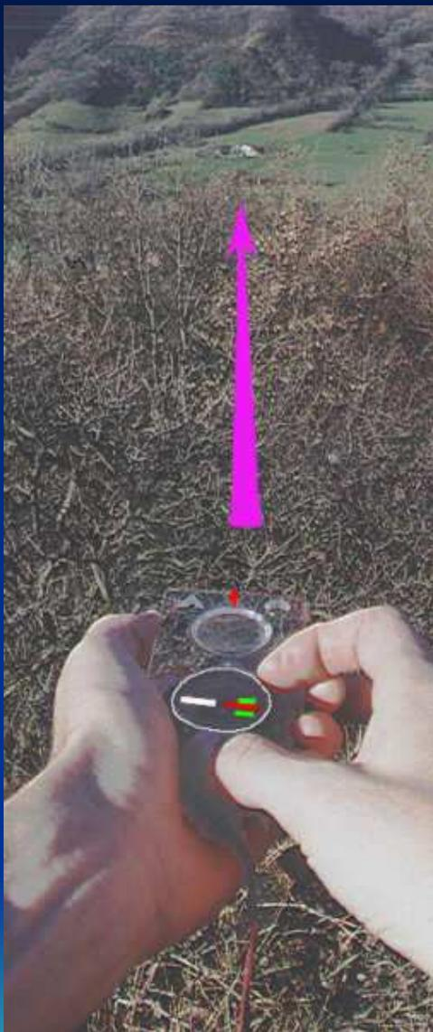
4) La maison **bien visée** faites tourner le **socle** de la boussole pour superposer l'**aiguille** de la boussole entre les **deux repères du socle**.
